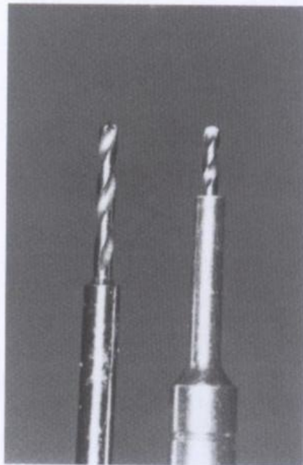
图3-14 左侧为0.6mm直径的螺旋钻，制备的钉洞用于容纳铸造修复体的平行钉柱部分，其切割部长度为5.0mm。右边为0.5mm直径的Kodex钻，制备的钉洞用于容纳固定银汞和复合树脂核的细螺纹钉。离钻尖2.0mm有一台领，以防止制备的钉洞过深
