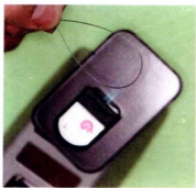
图6-1-13 弯曲镍钛丝后，用酒精灯外焰轻燎一下弯曲的部位，达到记忆的效果
