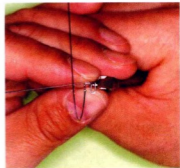
图6-2-71 弯折90°, 两个垂直臂平行并紧密接触
