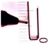
图4-9-6 在距离弯折部位6mm处作标记
