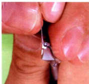
图4-1-11 调整钳夹持部位，沿圆喙继续弯折
