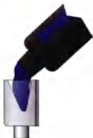
■ 图1-4-3B: 在模具中充填光固化材料。
